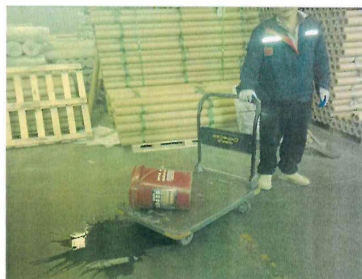
废油转运过程中发送泄露
